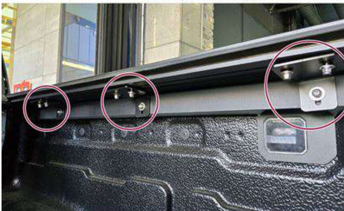
차량 측면 3곳에 “L브라켓”을 설치하여 롤스크린 커버 레일을 올립니다.
